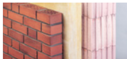
Prinzip Ausführung: Außenschale, Dämmung, Innenschale
